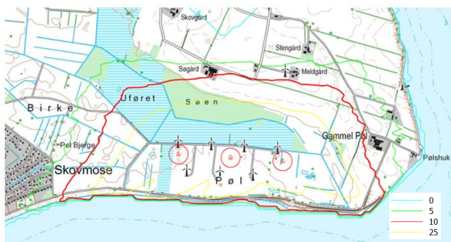
Fig. 7: Skyggekurver med "reelle" skyggetimer i et normalt år for 150 m høje møller
